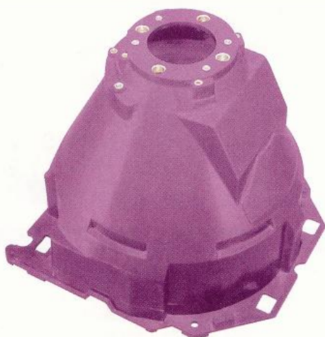
Support de tube cathodique pour matériel militaire. Matrice : EP – Renfort : FV. Inserts placés lors du moulage.
