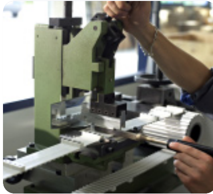
Orléans, soudure d'entraîneurs sur une courroie en polyuréthane.
